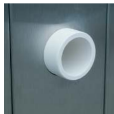
Schauloch in der Tür zur Brandkontrolle
