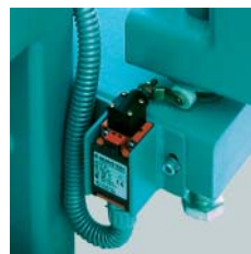
Personenschutzschalter an der Tür
