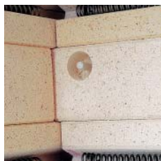
Thermo-Element, geschützt eingebaut
